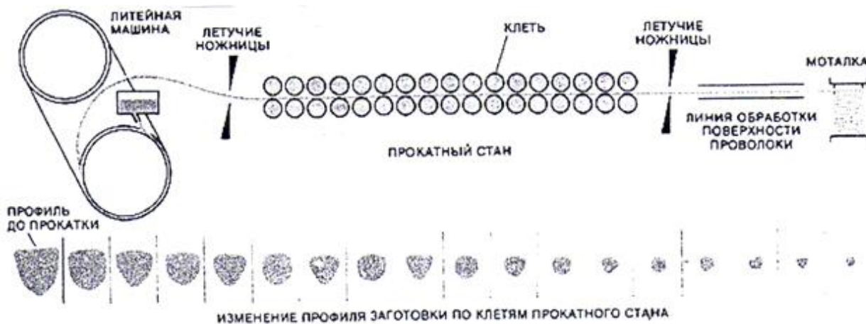
Рисунок 1.7 – Литейно-прокатный агрегат с роторным кристаллизатором
